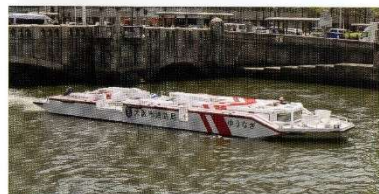
ゆうなぎ 平成24年5月就役(19トン) 「ゆうなぎ」は、低い橋梁の下を航行するために、操船室屋根の昇降装置と両舷に備えたタンク内の水量調整により船の高さを変えるバラスト装置を備えており、この特殊な構造により河川部での水難事故や消火活動にも対応できる消防艇です。
