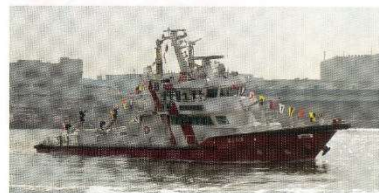
まいしま 平成12年3月就役(158トン) 「まいしま」は、放水砲等から消防車25台分(毎分5万ℓ)の放水能力をもち、船舶火災のほか海難事故、油流出事故、石油貯蔵施設での火災等にも対応できる多機能型消防艇です。
