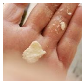
管の内側に積もっていた石灰の塊
