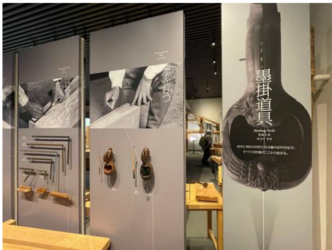
墨壺は直線を正確に引く道具。唯一彫刻が施されている。
