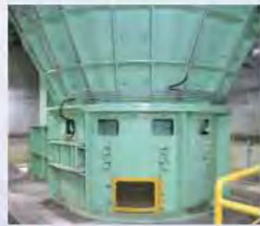
高速回転式破碎機 約100kgの鋼鉄製ハンマー36個が毎分590回転もの高速で回転し、投入された家具などの大型ごみを衝撃力で細かくします。
